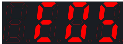
故障代号显示(外部电源故障)
