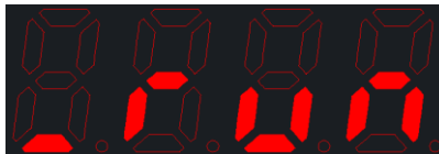
1#水泵运行(不使用互感器)
