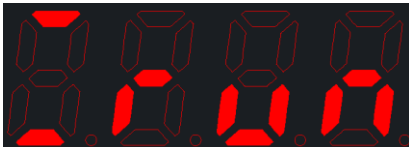
2#水泵运行(不使用互感器)
