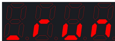
1#水泵运行(不使用互感器)
