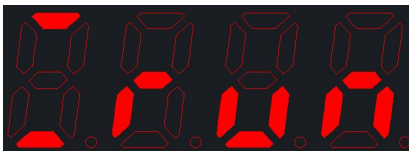
2#水泵运行(不使用互感器)
