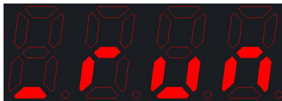
1#风机运行(不使用互感器)
