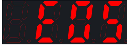
故障代号显示(外部电源故障)
